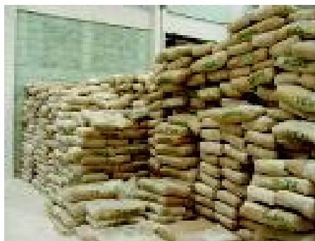
Figura 3-4. Forma incorrecta de almacenar el sulfato de aluminio (1)
