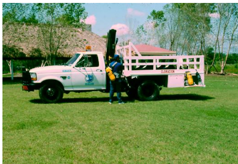
Figura 6-38. Vehículo equipado para emergencias originadas por el cloro (2)
