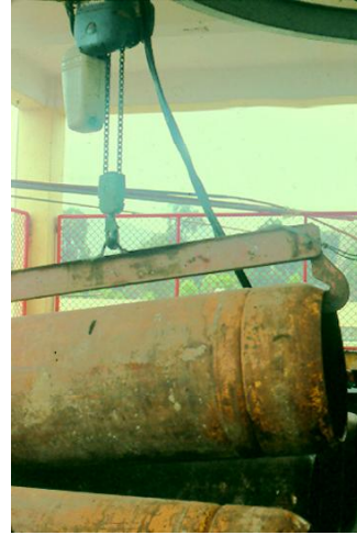
Figura 6-9. Sistema de grúa para cilindros grandes (2)
