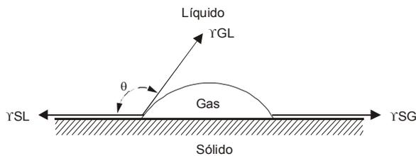
**Figura 8-1.** Ángulo entre la superficie del sólido y la burbuja de gas (1)
