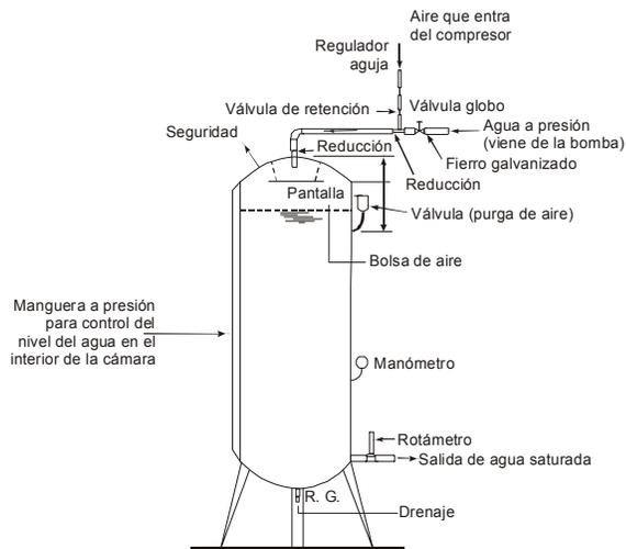
**Figura 8-9.** Cámara de presurización sin elementos de relleno
