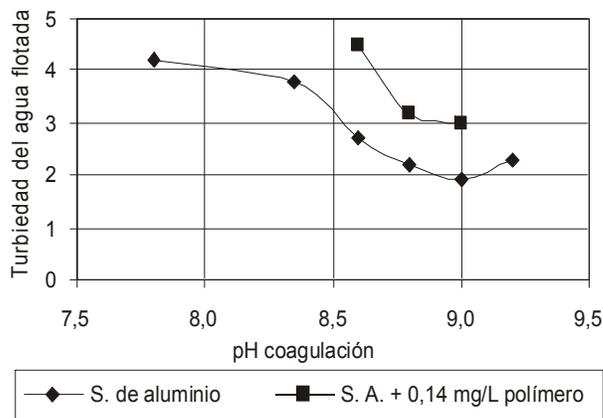
**Figura 8-15. Efecto del polímero en la calidad del efluente flotado**
