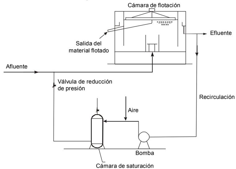
**Figura 8-6.** Sistemas de flotación por aire disuelto. Presurización de la recirculación
