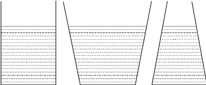
La presión es la misma en el fondo de todos los vasos. La presión depende de la profundidad del líquido y no de la forma del vaso.
