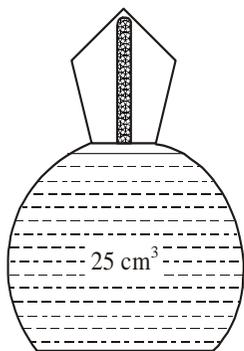
*Frasco de densidad.* Para determinar la densidad: (a) determine el peso del agua que llena el frasco; (b) determine el peso del líquido que lo llena; (c) divida el peso del líquido por el peso del agua.
